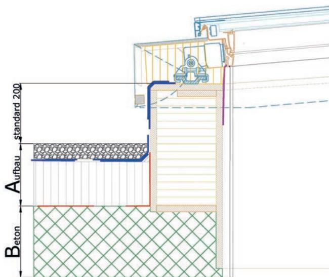
Die Unterkonstruktion zum Einbetonieren kann vom Baumeister selbst oder, als zusätzlicher Service, auch vom Flachdach-Anbieter versetzt werden.
