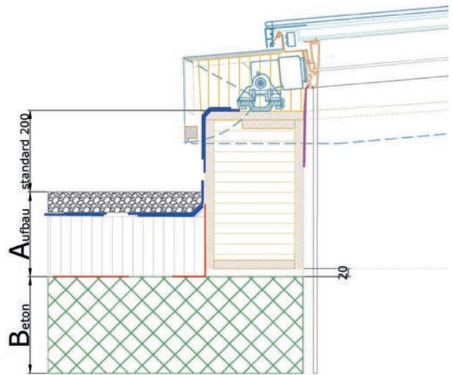
Die Unterkonstruktion zum Aufsetzen kann vom Polybauer, Holzbauer oder Flachdach-Anbieter versetzt werden (inkl. Montage der VMS-Module)
